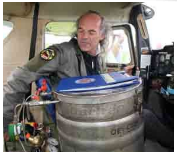
In diesem umgebauten Bierfass ist das Silberjodid untergebracht. Pilot Charly Schönberg kann die Dosierung während des Fluges per Hand steuern.
